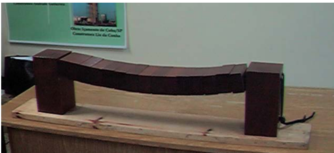
Figura 3: União de blocos pré-moldados de concreto.
